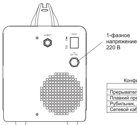
Конфигурация электропитания для сварочного аппарата
