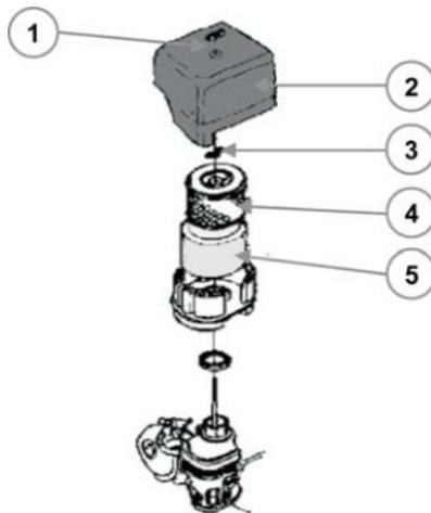
3. Внимательно проверьте оба элемента на отсутствие в них дыр и разрывов. Замените поврежденные элементы.
