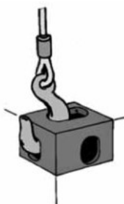
Пример захвата обычным крюком
